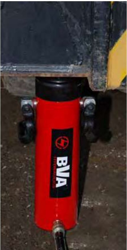
Cilindro de Simple Efecto H5513 en posición cerrada listo para elevar una carga.
