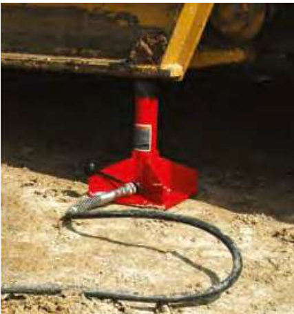
Cilindro de Simple Efecto H1506 en posición cerrada con la base de seguridad CB15.
