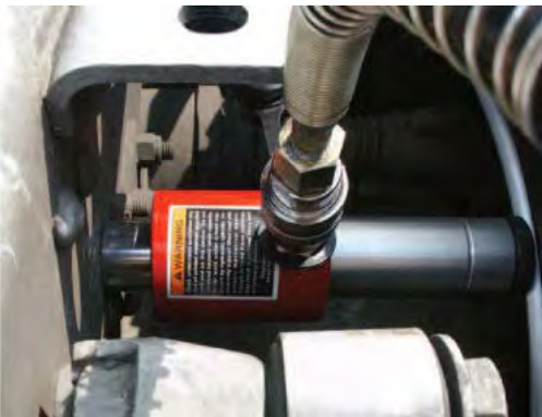
▲ Rueda de camión con la mini-prensa. Se ajusta entre el chasis y la rueda.
